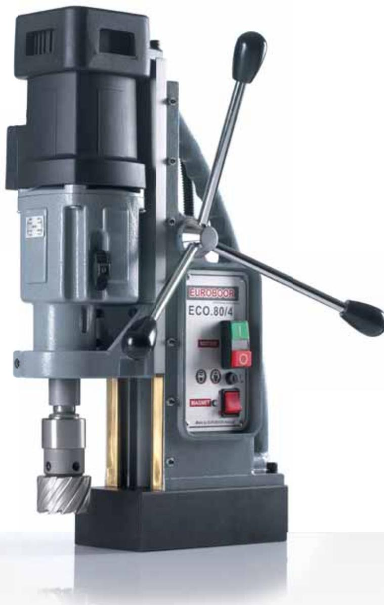
ECO.80/4 это мощный станок с соединением Конус Морзе 3. Благодаря 4 скоростям и механической защите мотора от перерузок, этот сверлильный станок идеально подходит для глубокого сверления длинными спиральными сверлами с захватом КМ.3 и диаметром до 31,75 мм.
